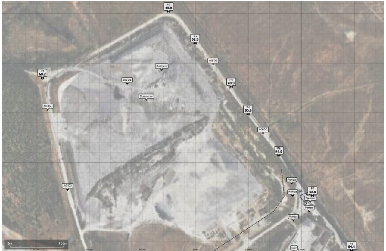
Disponerea surselor in zona de nord a amplasamentului (drum, celule depozitare, st epurare)
