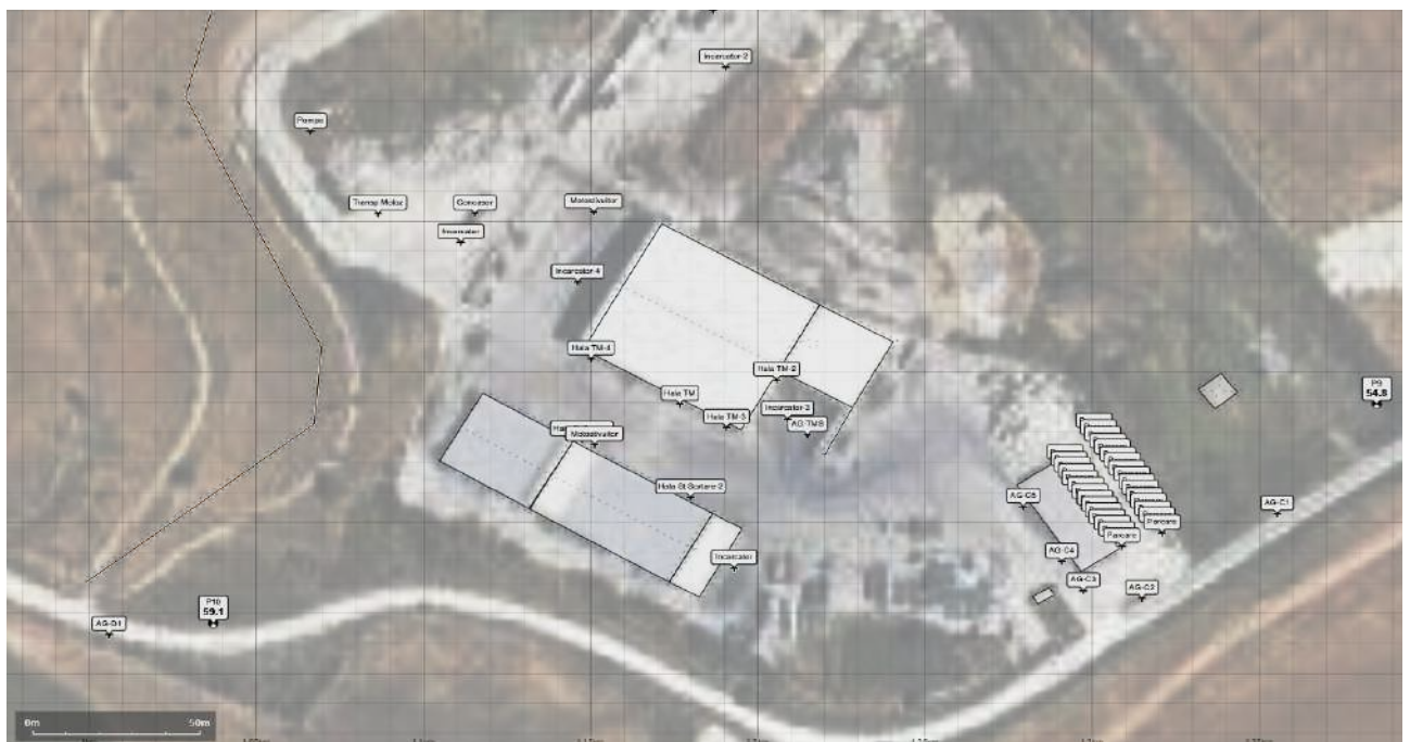
Disponerea surselor in zona de sud a amplasamentului (drum, cantar, parcare, platforma concasare, TM&TB, sortare)
